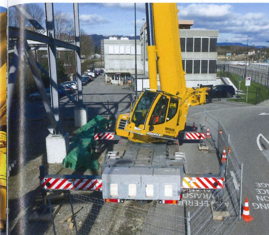
Das VarioBase des LTM 1120-4.1 lässt verkehrsseitig ausreichend Platz für andere Fahrzeuge.
